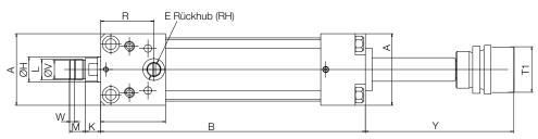
200: Mit 50 mm Gesamthub ohne Hubeinstellung, 4 Rückhubanschlüsse (90°), Vorhubanschluss beim RZHx05. axial und beim RZHx08. seitlich.
